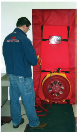
Blower Door Test
